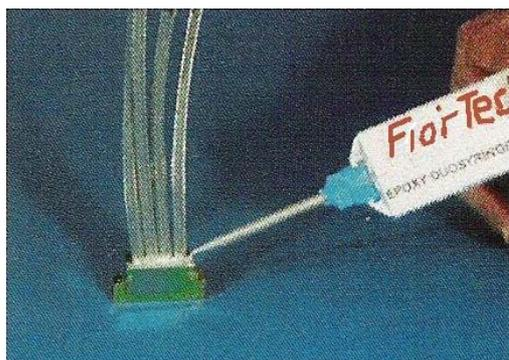
**RT183:** Adesivo conduttivo specificamente progettato per schermature e terminazioni di connettori per applicazioni EMC. E' molto facile da utilizzare, può essere polimerizzato a temperatura ambiente o in forno, opera fino a 150°C e può essere conservato a temperatura ambiente fino a 6 mesi.
